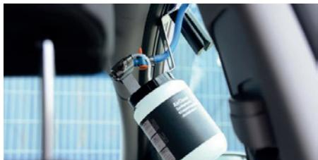
7. Schalten Sie das Gebläse auf mittlerer Stufe bei ca. 20°C ein, öffnen Sie alle Luftpulen und stellen Sie die Lüftung auf Umluft. Stellen Sie eine externe Spannungsversorgung des Bordnetzes her oder lassen Sie den Motor laufen.
