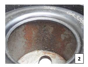
Um das Lager richtig abzudichten, muss die Kunststoffkappe nach Montage und Einstellung der Spannrolle so eingesetzt werden, dass diese einrastet (Abb. 3). Fehlt die Kappe oder ist sie nicht richtig eingesetzt, verschleißt das Lager in kurzer Zeit, sodass im Betrieb Laufgeräusche hörbar sind.
