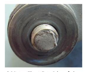
Das dadurch entstehende Spiel zwischen Rolle und Motor überträgt sich auf den Zahnriemen und führt zu einem Fluchtungsfehler.
